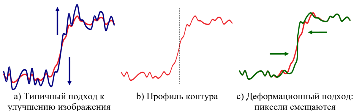
Рис. 2 Идея повышения резкости контуров изображения методом деформации сетки
